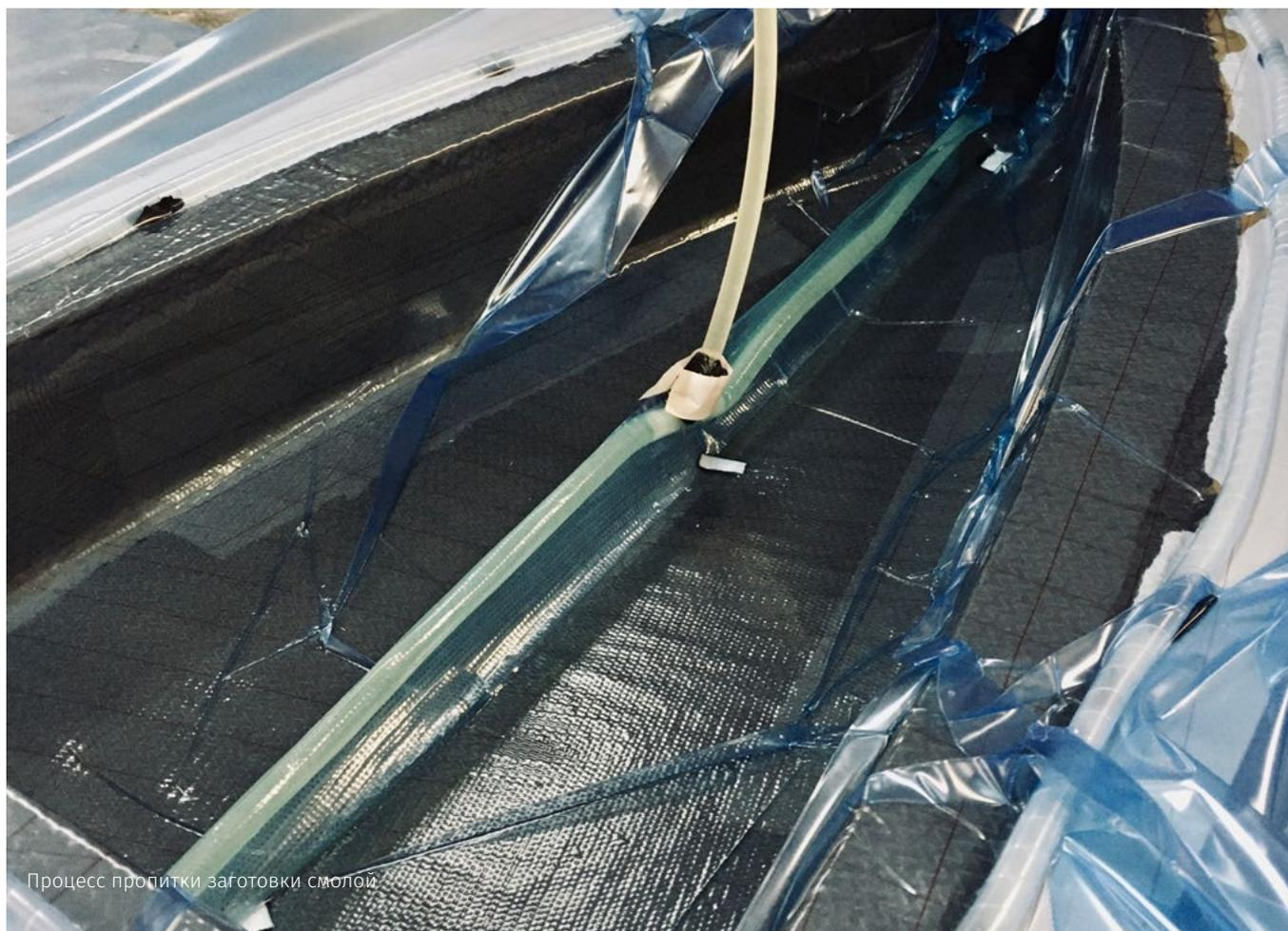
Процесс пропитки заготовки смолой
