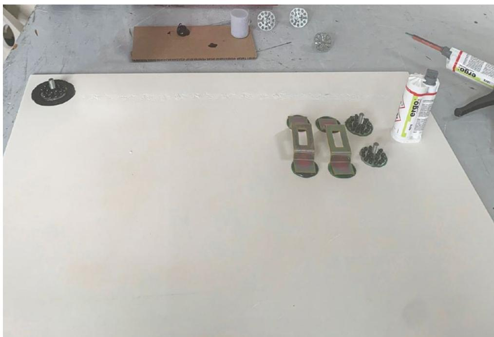
**Рисунок 1.** Металлические головки и скобы, приклеенные на стеклопластик
