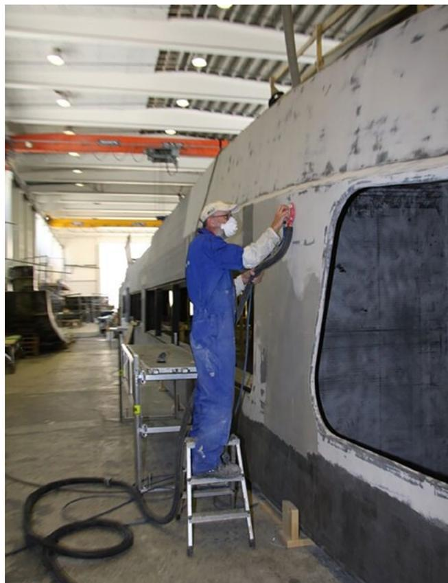
**Рис. 3.** Отделка надстройки скоростного катамарана из композитов
