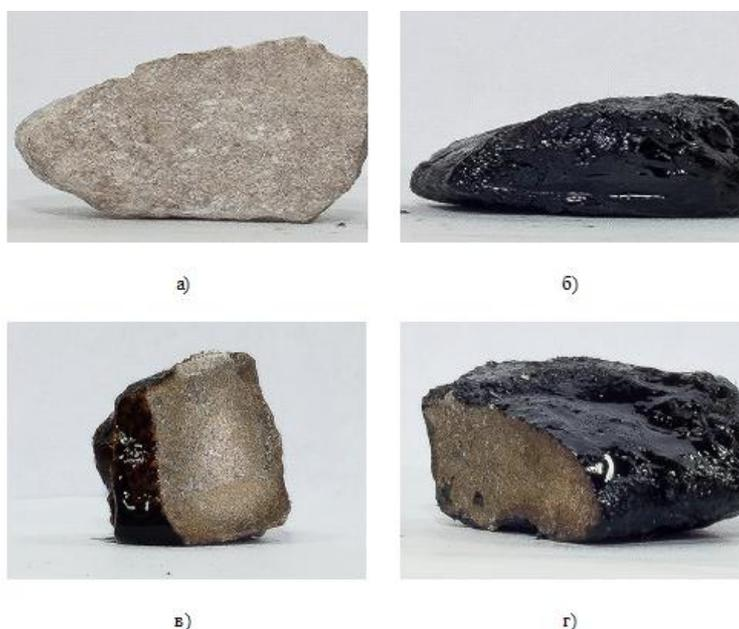
**Рисунок.** Фотографии образцов щебня: а) исходный образец; б) внешний вид образца щебня после процесса пропитки; в) срез образца после пропитки в условиях №1 (табл. 1); г) срез образца после пропитки в условиях №4 (табл. 1)
