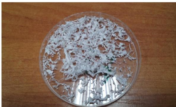
Рис. 4. PLA при давлении 40 МПа и температуре 150°C
