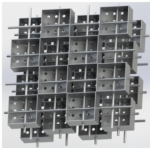
**Рис. 1.** Вид сверху на струйно-барботажное контактное устройство
