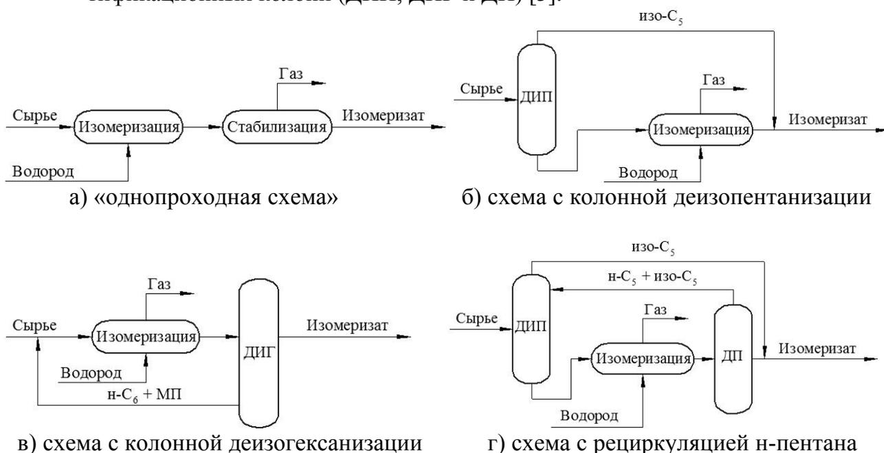
**Рисунок.** Схемы процессов изомеризации: а), б), в), г)
