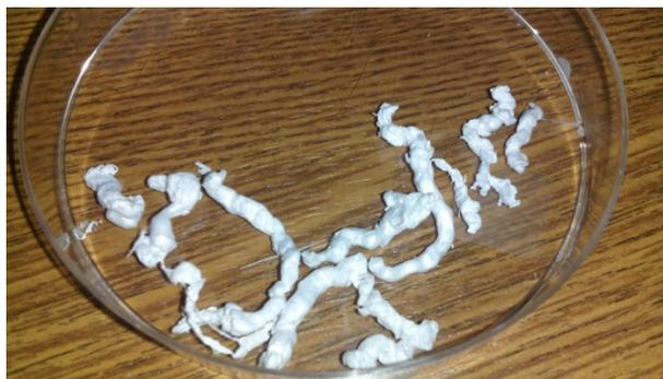
**Рис. 2.** PLA при давлении 20 МПа. и температуре 150 °С
