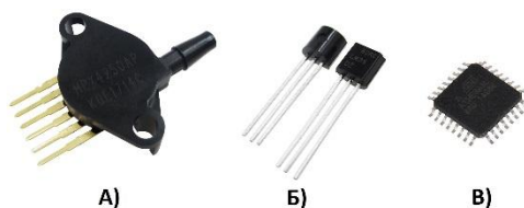
Рис. 4. а) ДАД MPX4250AP; б) ДТ LM35; в) Atmega8
