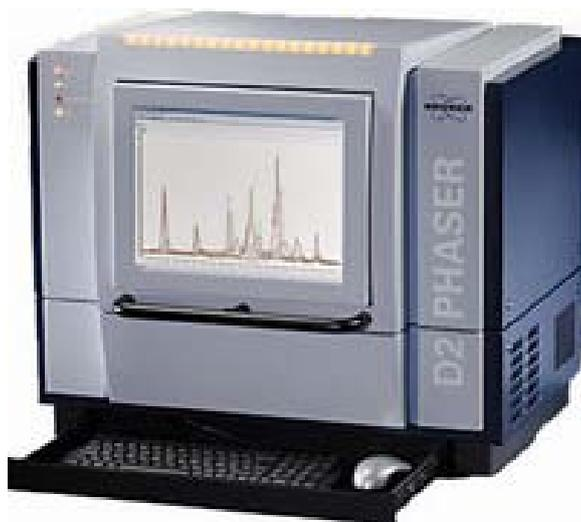
Дифрактометр «D2 Phaser» – рентгеноструктурное исследование материалов; качественный фазовый анализ с использованием баз данных ICDD PDF-2, PDF-4; определение степени кристалличности; определение размеров микрокристаллов (ОКР). Рентгеновское излучение  $\text{Co-}\alpha$ .
