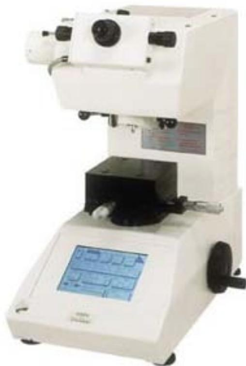
Микротвердомер Shimadzu HMV-2T – измерение микротвердости различных объектов (от тонких металлических пленок и лакокрасочных покрытий до шлифов геологических образцов и деталей машин).
