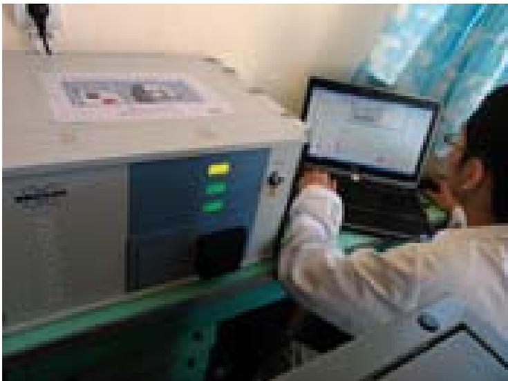
Рентгеновский спектрометр Bruker S2 PICOFOX – экспресс-анализ элементного состава жидкостей, суспензий и порошкообразных веществ и материалов. С помощью спектрометра S2 PICOFOX можно определять все элементы от алюминия до урана (кроме ниобия, молибдена и технеция).
