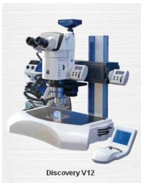
Стереомикроскоп Stereo Discovery.V12 – исследование объемных объектов с широким полем зрения и большим рабочим расстоянием (до 80мм), что обеспечивает большую глубину резкости и возможность проводить анализ поверхности образца.
