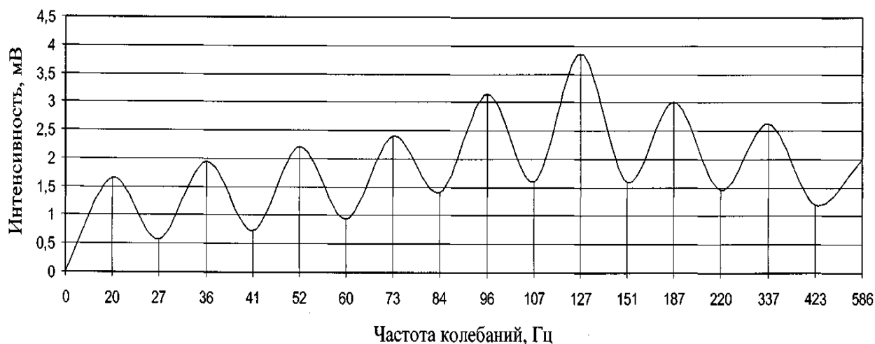
Рисунок 3 - Резонансные кривые (полиуретановый)
