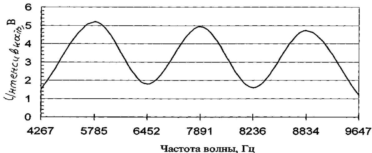
Рисунок 2 - Резонансные кривые для наиритового клея в области высоких частот
