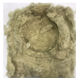
б) базальтовая вата после нанесения ПВА-30% образец 1900 оборотов
