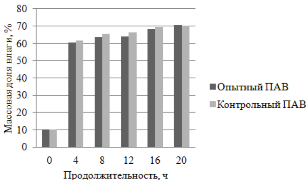
Рисунок 2 – Зависимость массовой доли влаги в кожевой ткани шкурок песка от продолжительности мойки и отмоки (мойка: нПАВ 1,5 г/дм 3 , аПАВ – 2,0 г/дм 3 ; отмока: нПАВ 0,5 г/дм 3 и аПАВ 0,5 г/дм 3 )
