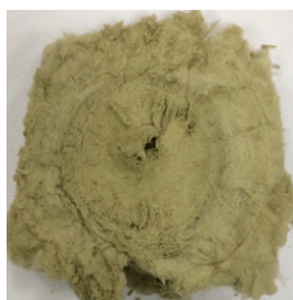
а) базальтовая вата контрольный образец 1900 оборотов
