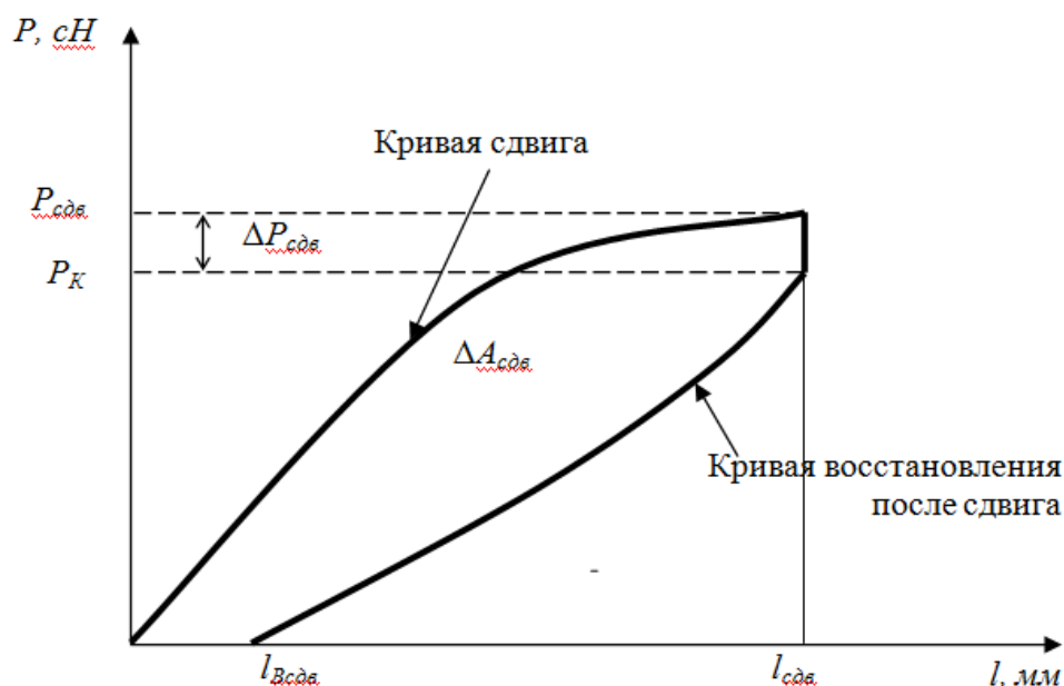
Рисунок 1 - Графическая запись процесса сдвига нитей в ткани и восстановления
