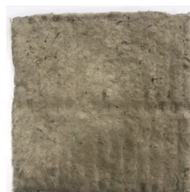
б) базальтовый картон после нанесения ПВА-30% образец 1200 оборотов
