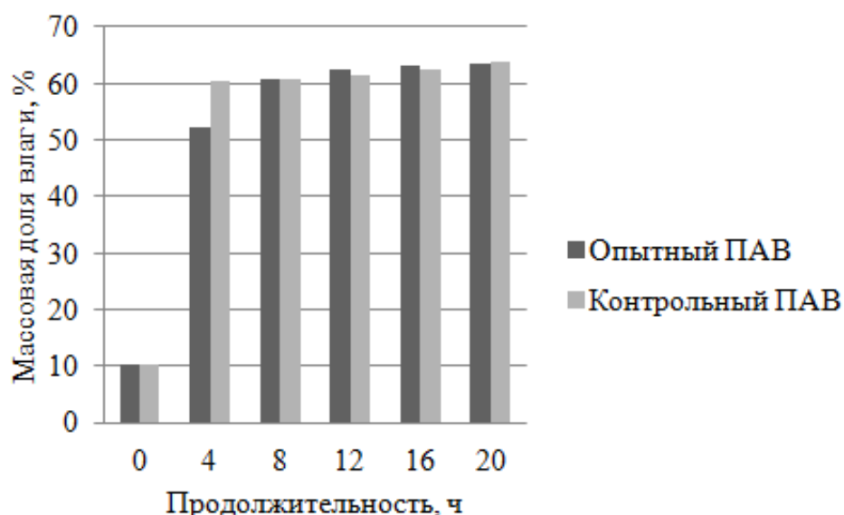
Рисунок 1 – Зависимость массовой доли влаги в кожной ткани шкурок песка от продолжительности мойки и отмоки (мойка: нПАВ 1,0 г/дм 3 , аПАВ – 2,0 г/дм 3 ; отмока: нПАВ 0,5 г/дм 3 и аПАВ 0,5 г/дм 3 )
