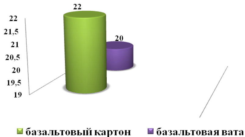
Рисунок 3 – Значения привеса строительных утеплителей после нанесения ПВА-30%
