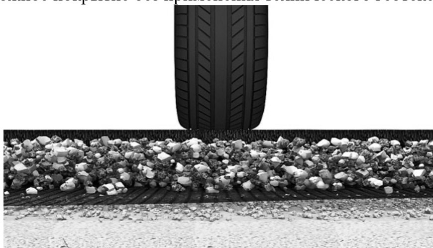
б - Дорожное покрытие с применением технического геотекстиля
