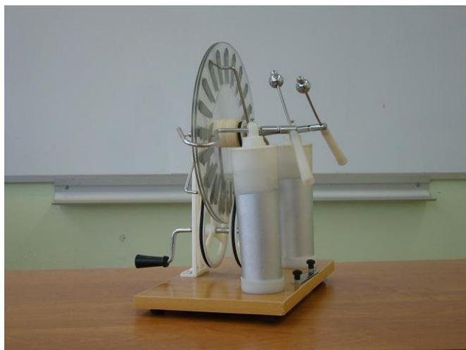
Рис. 2. Электрофорная машина
