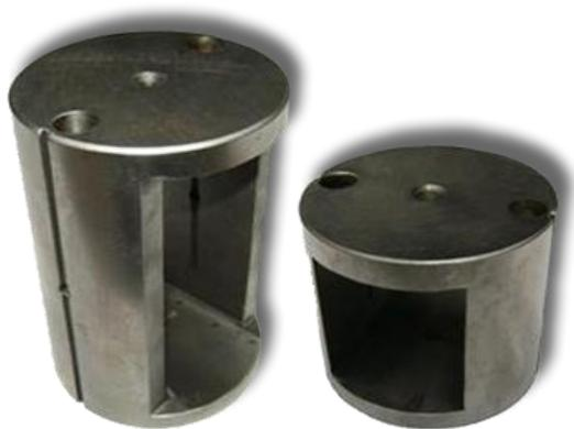
Рисунок – 16 – Направляющий аппарат
