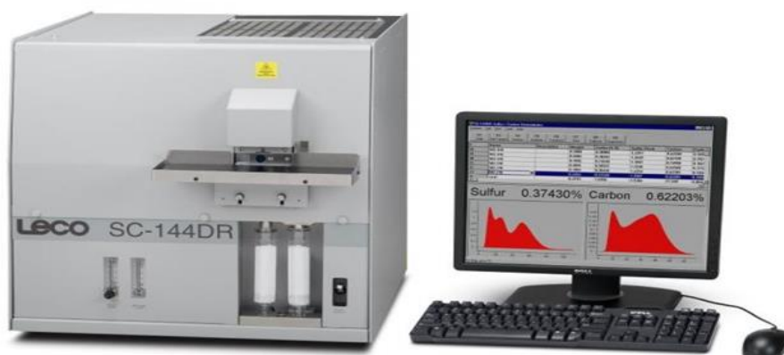
Рисунок 1 – Анализатор серы и углерода «LECO SC-144DR»
