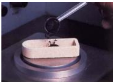
Рисунок 2 – Лодочка, используемая для сжигания образца.
