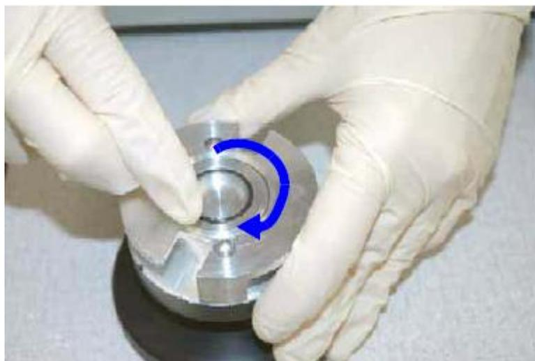
Рисунок 5 – Процедура обработки резинового кольца вакуумной смазкой
