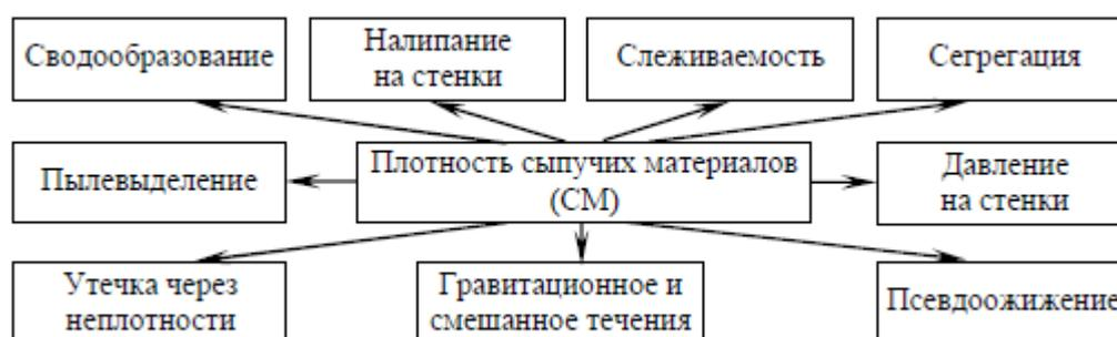
Рисунок 1 – Влияние плотности сыпучих материалов на различные технологические процессы и явления
