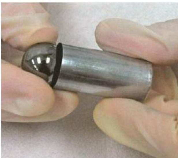
Рисунок 9 – Процесс помещения калибровочных шариков в тубу
