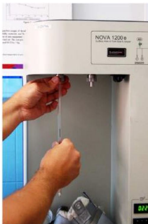
Рисунок 16 – Установка измерительной ячейки в станцию дегазации
