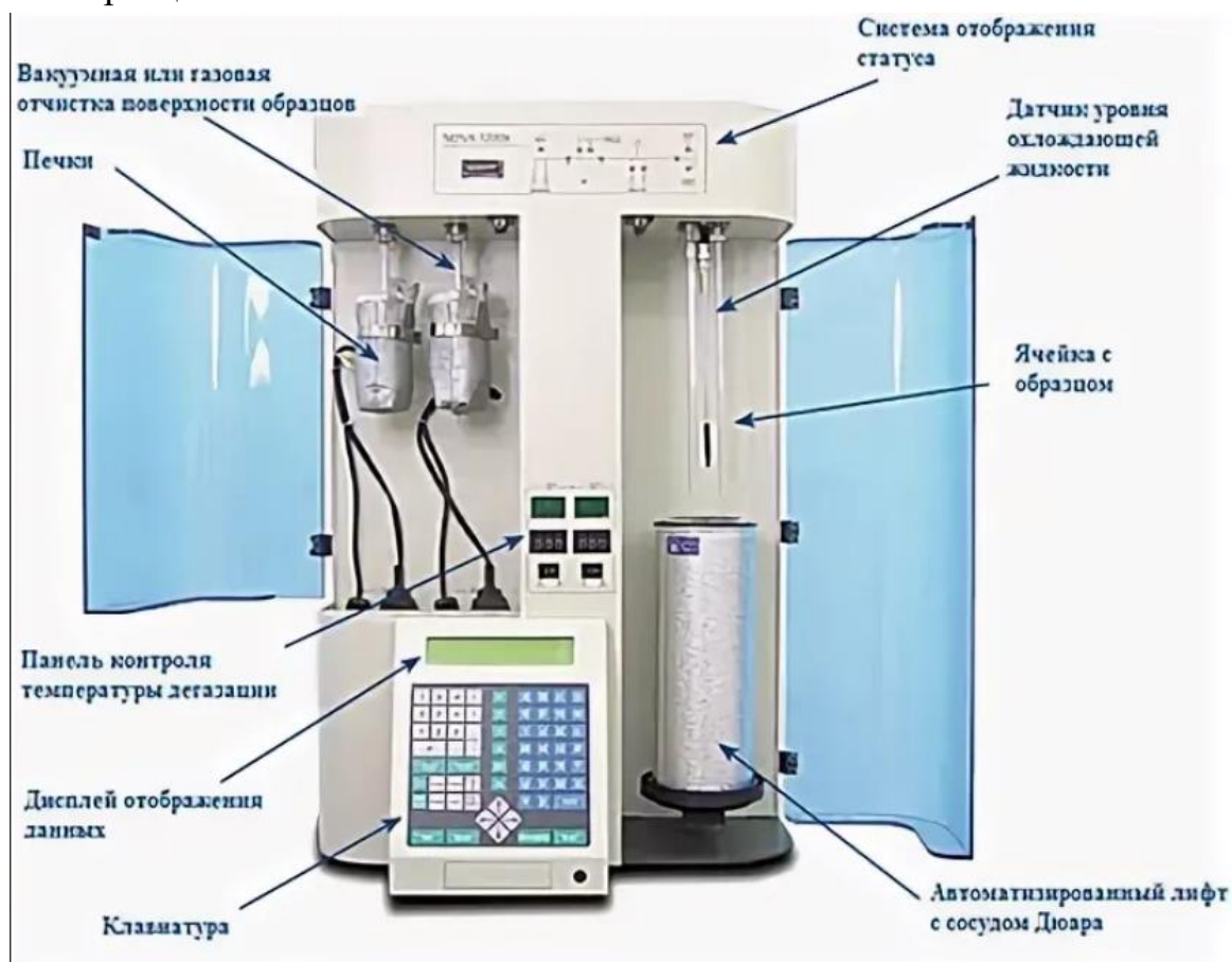
Рисунок 8 – Схема прибора NOVA 1200e Quntachrome
