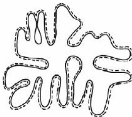
Рисунок 2 - Схематическое сечение частицы с поверхностью, исследованной методом адсорбции, монослой адсорбата показан пунктирной линией
