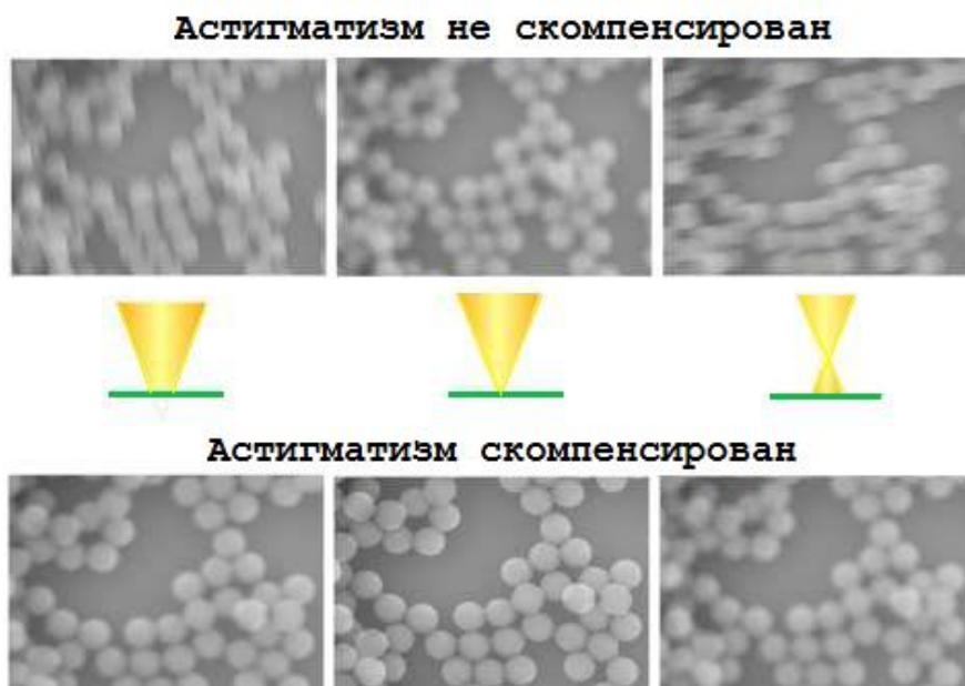
Рис. 15. Размытие изображения при фокусировке выше и ниже образца при наличии астигматизма (вверху) и без астигматизма (внизу).
