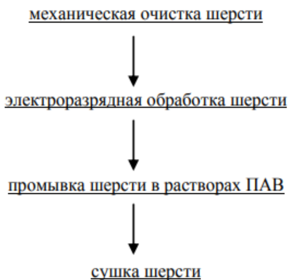
Рисунок 3. Технология первичной обработки шерсти с применением ЭРНОК
