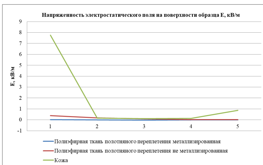
Рисунок 3 – Результаты измерения напряженности электростатического поля на поверхности трех образцов
