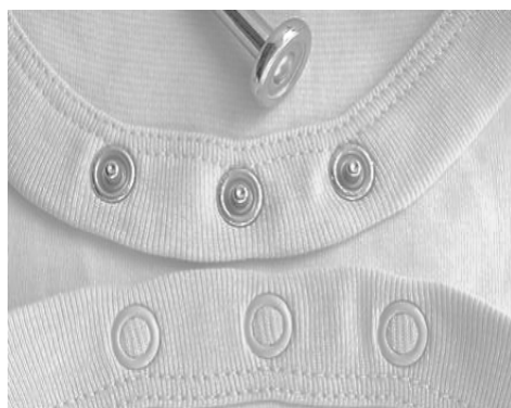
Рис. 4 – Способы соединения модульного костюма на основе кнопок (а- видимые с лицевой стороны кнопки, б- накладные, не видимые с лицевой стороны)
