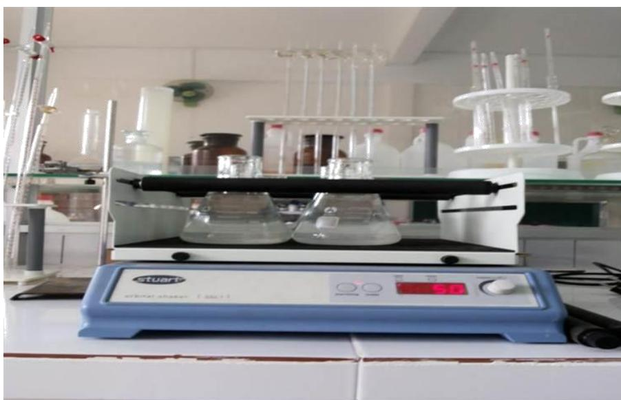
Рис. 2.3. Экспериментальное погружение порошковых материалов *in vitro* в раствор **SBF**
