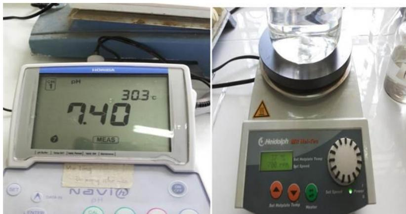
Рис. 2.2. Регулировка pH 7.4 и температуры (37°C) во время синтеза **SBF**
