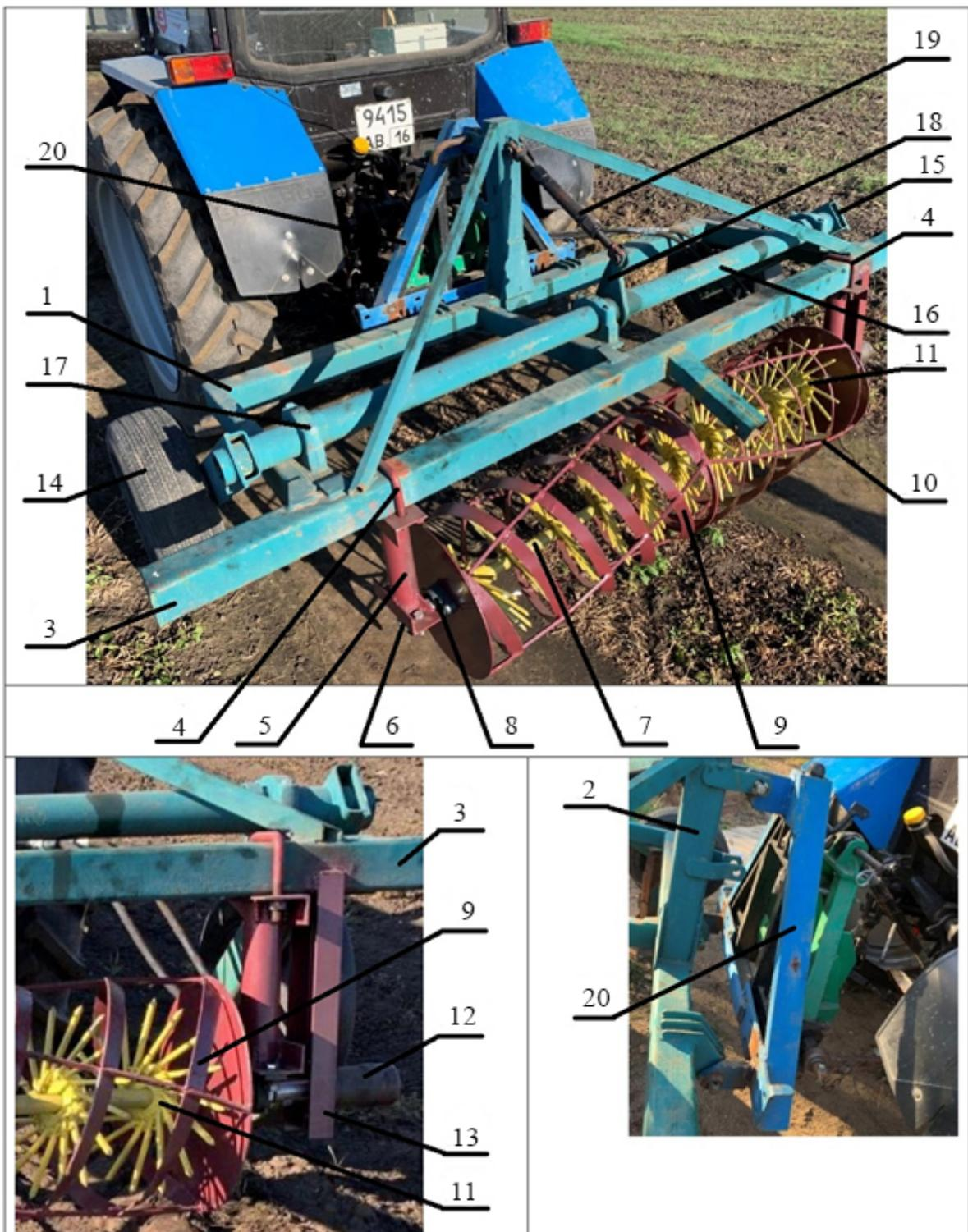
Рисунок 3.1 – Опытный образец орудия: 1 – рама; 2 – система навески; 3 – несущая балка; 4 – хомуты; 5 – стойки; 6, 8, 17 – подшипниковые опоры; 7 – горизонтальный вал; 9 – спирально-винтовой рабочий орган; 10 – винтовые квадратные прутки; 11 – эллипсовидные игольчатые диски; 12 – гидромотор; 13 – стойка гидромотора; 14 – опорные колеса; 15 – поводки; 16 – труба; 18 – рычаг; 19 – регулировочная тяга; 20 – тензометрическая навеска
