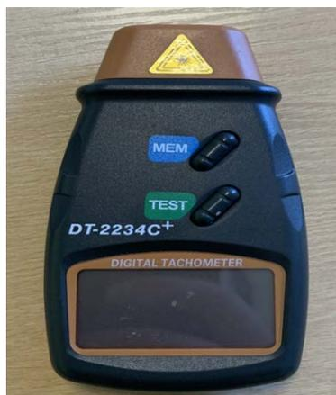
*Рисунок 3.3 – Лазерный бесконтактный тахометр*
