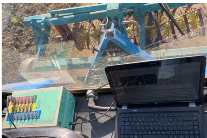
*Рисунок 3.11 – Измерительно – информационная система с компьютером*
