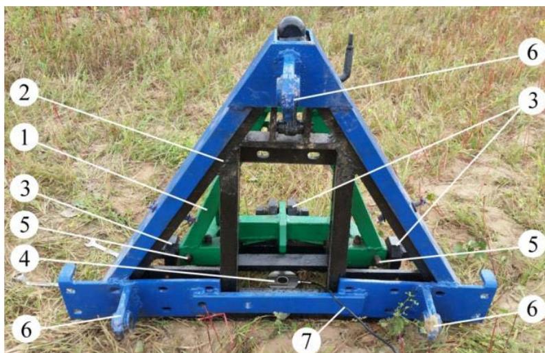
*Рисунок 3.2 – Тензометрическая навеска: 1, 2 – треугольные конструкции; 3 – шарниры; 4 – S-образный датчик; 5 – упорные болты; 6 – кронштейны; 7 – электрический кабель*
