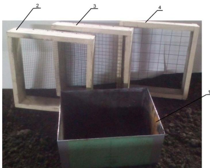
*Рисунок 3.8 – Контейнер с лабораторными ситами: 1 – контейнер; 2, 3, 4 – сита лабораторные*
