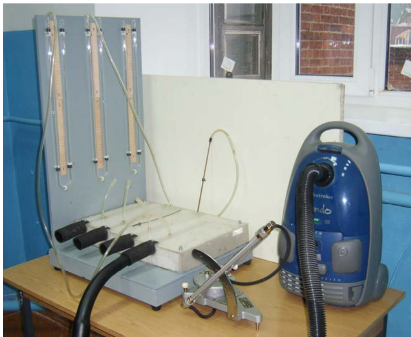
Рис. 1. Компактный лабораторный стенд для измерения параметров газового потока
