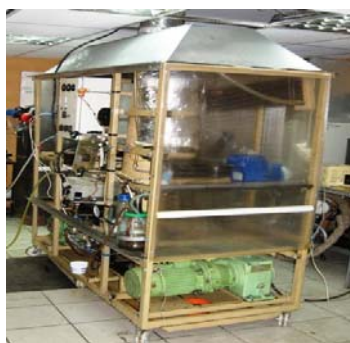
Рис. 2. Пилотная проточная установка для исследований процесса СКВО
