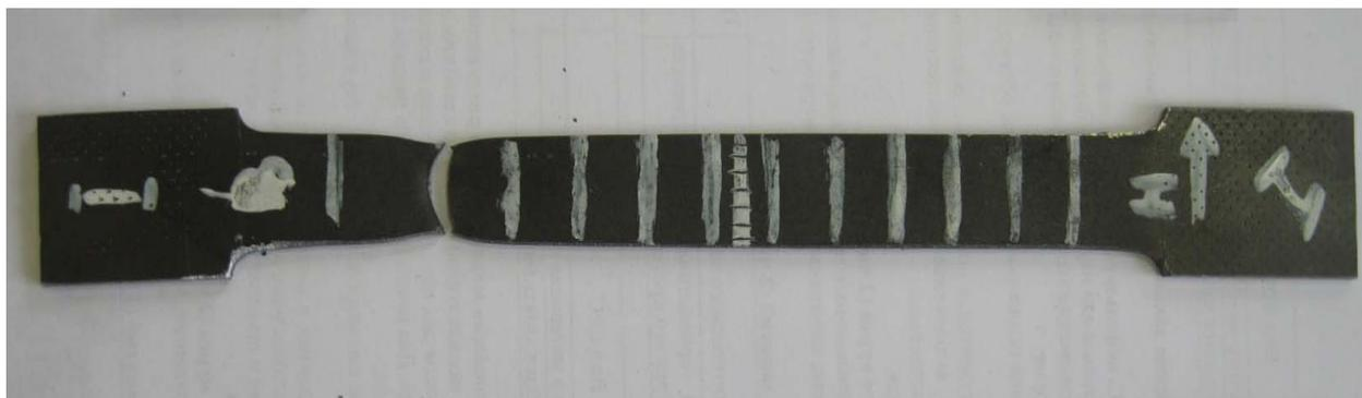
Рис. 3. Экспериментальный образец после разрыва
