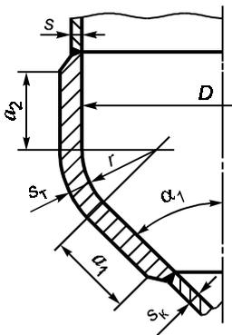
Рисунок 26 — Соединение обечайки с тороидальным переходом
