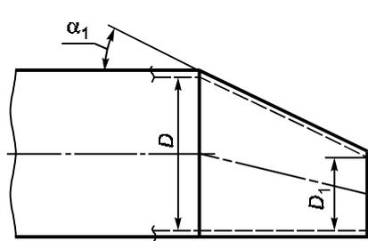
Рисунок 28 — Соединение кососимметричных обечайки
