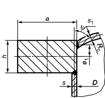
Рисунок 13 — Сферическое неотбортованное днище с укрепляющим кольцом
