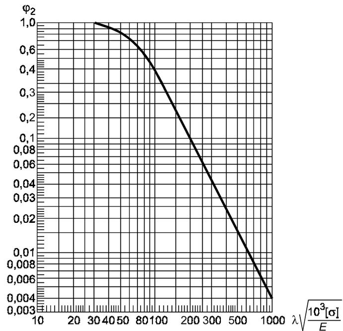
Рисунок 6 — График для определения коэффициента  $\varphi_2$
