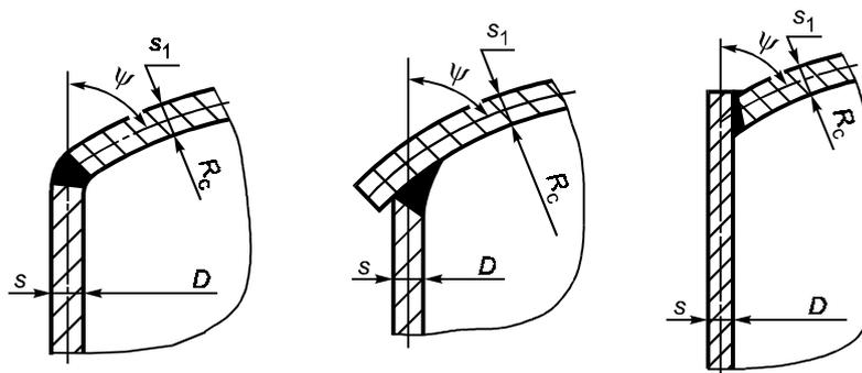
Рисунок 12 — Сферические неотбортованные днища без укрепляющего кольца
