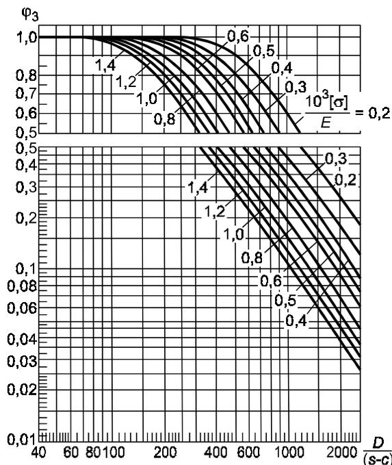
Рисунок 7 — График для определения коэффициента  $\varphi_3$
