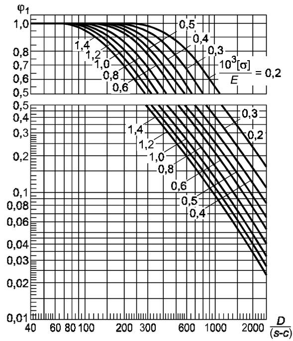
Рисунок 5 — График для определения коэффициента  $\varphi_1$
