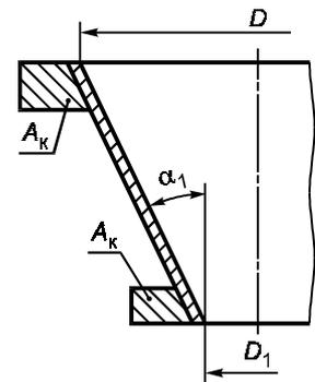
Рисунок 29 — Коническая обечайка с кольцами жесткости
