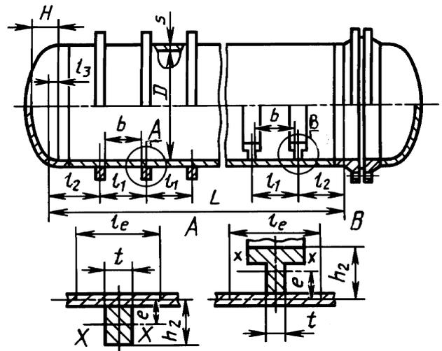
Рисунок 4 — Цилиндрическая обечайка, подкрепленная кольцами жесткости
