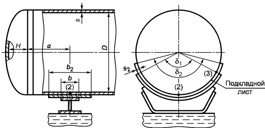
а — цилиндрическая обечайка, не подкрепленная элементами жесткости
