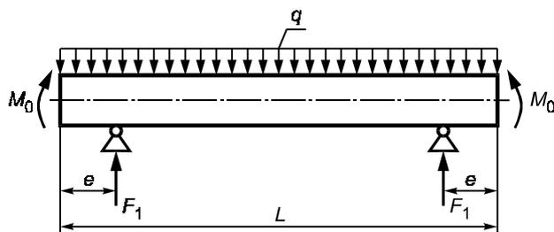
Рисунок 10 — Расчетная схема определения усилий
