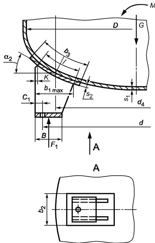
Рисунок 12 — Опорная стойка на эллиптическом днище
