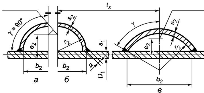
а — полукруглое сечение с V-образным швом; б — полукруглое сечение с угловым швом; в — сегментное сечение
