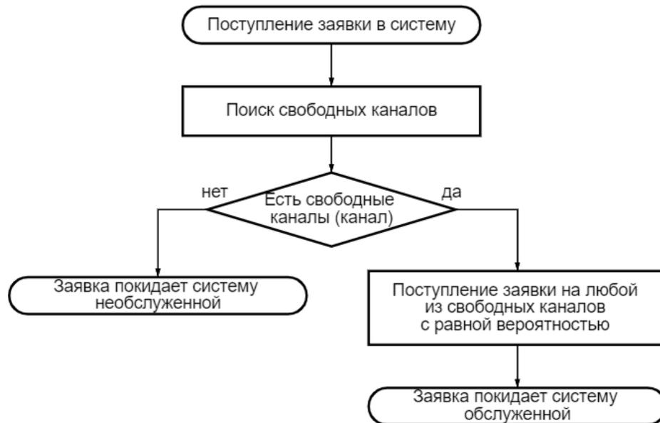
Рисунок 2.17 – Блок-схема алгоритма управления потоком с равновероятным распределением заявок (предложена автором)
