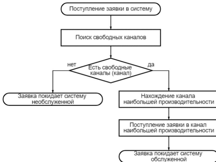
Рисунок 2.19 – Блок-схема алгоритма управления потоком с приоритетом канала наибольшей производительности (предложена автором)
