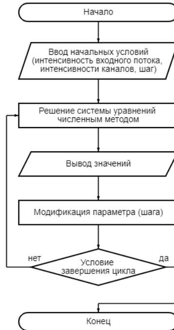
Рисунок 2.10 – Алгоритм численных расчетов СМО с неэквивалентными приборами в нестационарном режиме (предложен автором)
