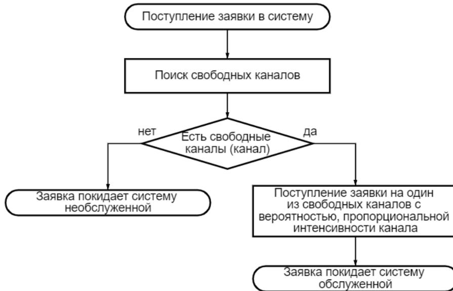
Рисунок 2.18 – Блок-схема алгоритма управления потоком с пропорциональным распределением заявок (предложена автором)
