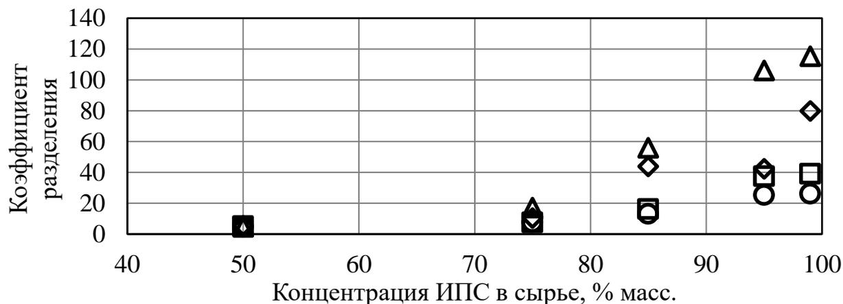
Рисунок 28 – Зависимость коэффициента разделения от концентрации воды в сырье при обезвоживании изопропилового спирта мембранами АЭФК и АЭБК: треугольник – при температуре 40 °С АЭФК-5-ПЭГ; ромб – при температуре 60 °С АЭФК-5-ПЭГ; квадрат – при температуре 40 °С АЭБК; круг – при температуре 60 °С АЭБК
