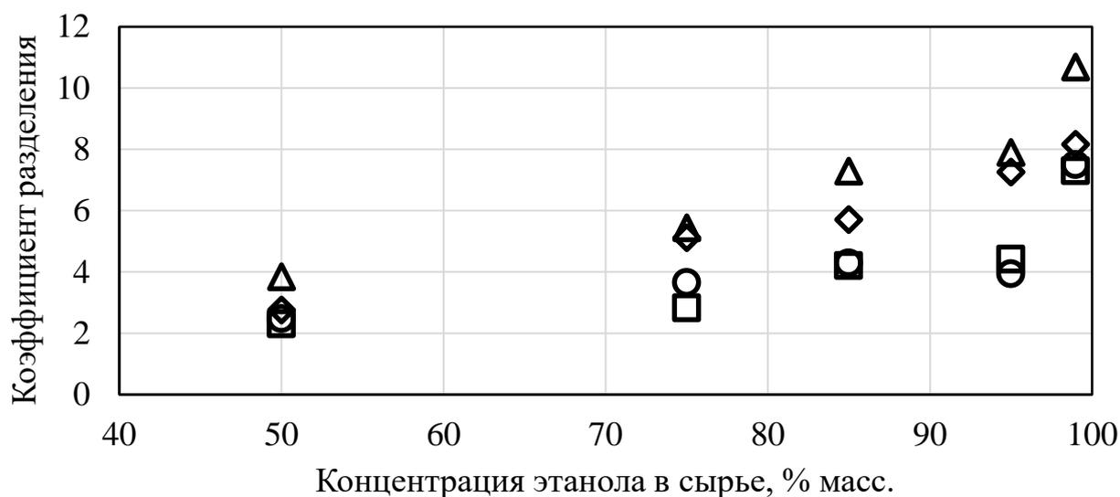
Рисунок 30 – Зависимость коэффициента разделения от концентрации этилового спирта в сырье при различных температурах исходного сырья для мембран АЭФК и АЭБК: треугольник – при температуре 40 °С АЭФК-5-ПЭГ; ромб – при температуре 60 °С АЭФК-5-ПЭГ; квадрат – при температуре 40°С АЭБК; круг – при температуре 60°С АЭБК
