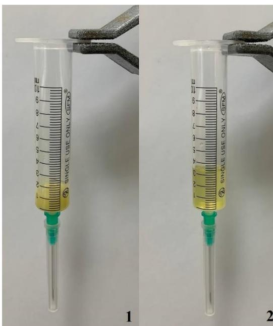
Рисунок 17 – Компоненты раствора полимера на различных стадиях перемешивания: 1 – смесь полиизоционата и иономера; 2 – смесь трех компонентов готового раствора полимера
