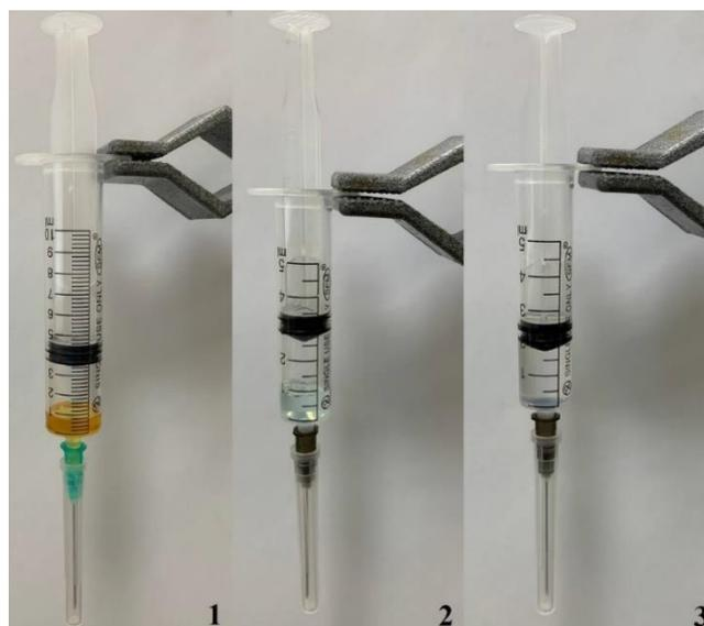
Рисунок 16 – Компоненты раствора полимера: 1 - полиизоционат; 2 – иономер (АЭФК/АЭБК); 3 - ацетон химический чистый
