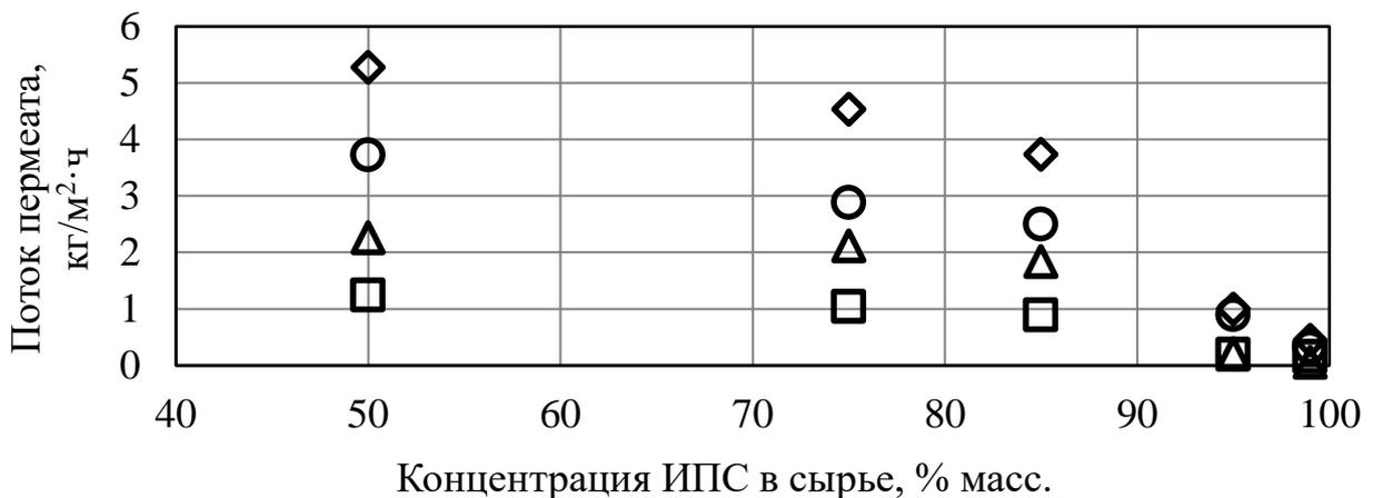
Рисунок 27 – Зависимость потока пермеата от концентрации изопропилового спирта в сырье при различных температурах исходного сырья для мембран АЭФК и АЭБК: треугольник – при температуре  $40 \text{ }^\circ\text{C}$  АЭФК-5-ПЭГ; ромб – при температуре  $60 \text{ }^\circ\text{C}$  АЭФК-5-ПЭГ; квадрат – при температуре  $40^\circ\text{C}$  АЭБК; круг – при температуре  $60^\circ\text{C}$  АЭБК
