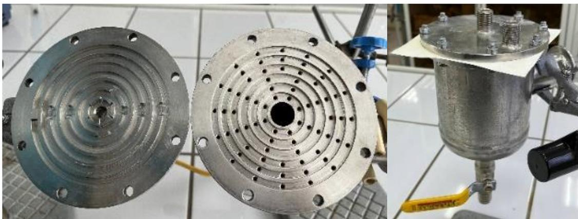
Рисунок 20 – (a) Схема экспериментальной первапорационной установки: 1 – сырьевая емкость с обогревом; 2 – циркуляционный насос; 3 – мембранный модуль; 4, 5 – холодные ловушки; 6 – криостат; 7 – вакуумный насос; 8 – баллон с инертным газом; (b) Конструкция верхней и нижней крышек мембранного модуля с совпадающими лабиринтными каналами; (c) Внешний вид мембранного модуля с лабиринтовыми крышками, между которыми зажата плоская первапорационная мембрана
