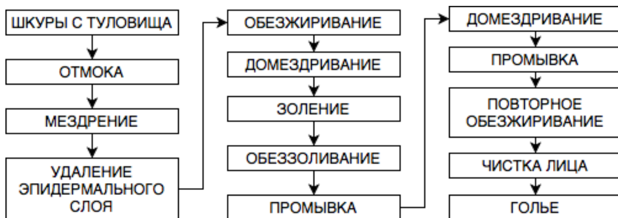
Рисунок 18 – Технологическая схема получения голя из шкур с туловища страуса
