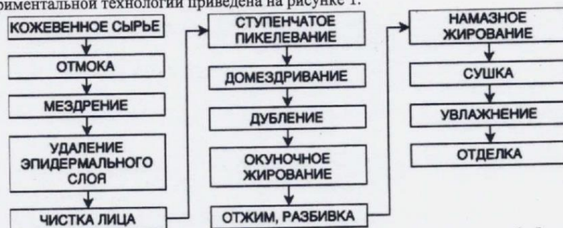
Рисунок 1 – Последовательность операций получения кожевенного полуфабриката из шкур с ног страуса по экспериментальной технологии
