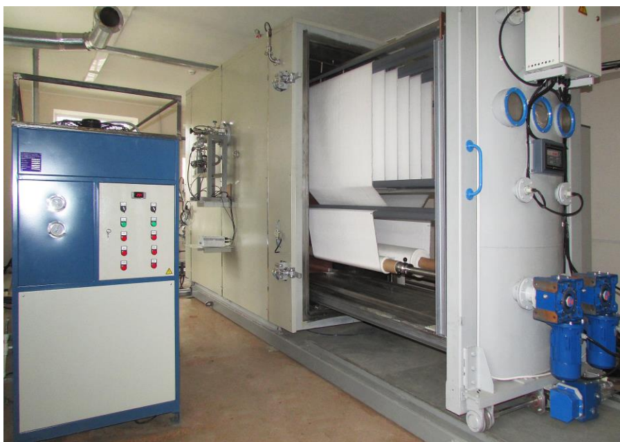
Рис. 2.2 – ПЛУ «ВАТТ 4000 ПТ ПЛАЗМА» в процессе обработки ТМС
