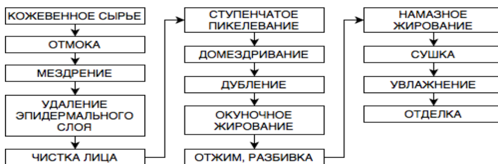
Рисунок 1 – Последовательность технологических операций получения кожевенного полуфабриката по экспериментальной технологии
