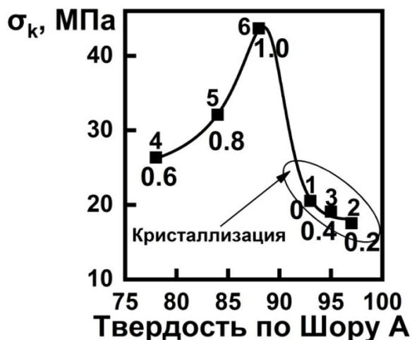
Рисунок 4.14 – Влияние твердости по Шору А на прочность образцов серии СПВ. Нумерация точек на рисунке соответствует номерам образцов серии СПВ. Под точками указано мольнаядоля МОСА в отверждающей смеси
