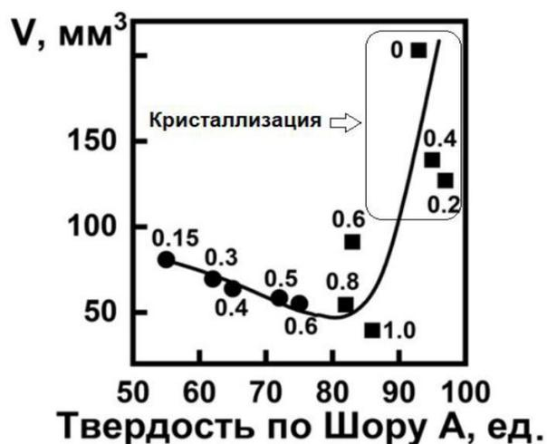
Рисунок 4.15 – Влияние твердости по Шору А на объемный износ образцов эластомеров серий СПВ (■) и ПШБ (●). Рядом с точками указана мольная доля МОСА в отверждающей смеси
