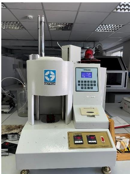
*Рисунок 4.24 – Внешний вид установки для определения показателя текучести расплава Gotech GT-7100-MIB*
