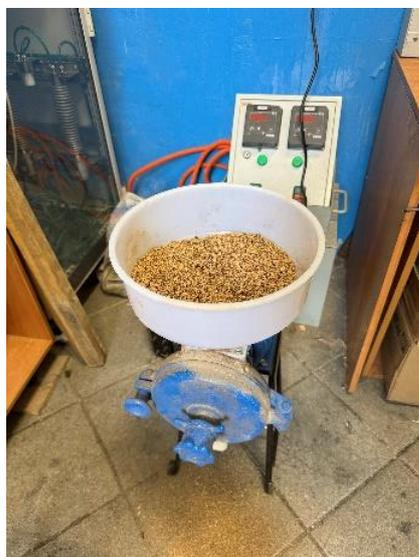
*Рисунок 3.5 – Роторно-ситовой дисмембратор марки ДРС-2,0*
