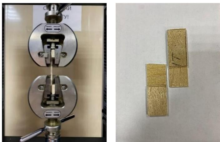
Рисунок 4.9 – Определение прочности на сдвиг по клеевому соединению
