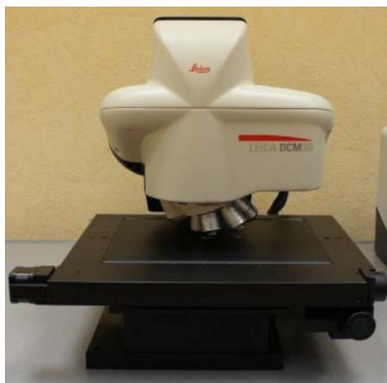
*Рисунок 4.16 – Конфокальный оптический микроскоп Leica DCM 3D*
