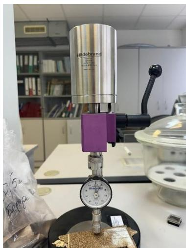
Рисунок 4.19 – Определение твёрдости полученных ДПК
