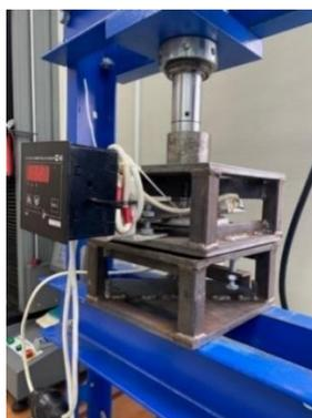
*Рисунок 4.7 – Горячий пресс для склеивания образцов*
