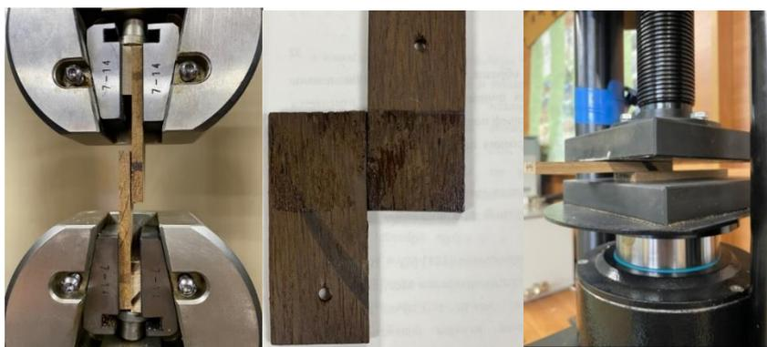
*Рисунок 4.3 – Определение прочности на разрыв древесины*
