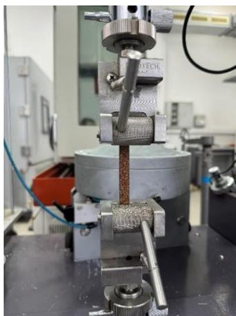
*Рисунок 4.22 – Крепление образцов композита на испытательной машине*
