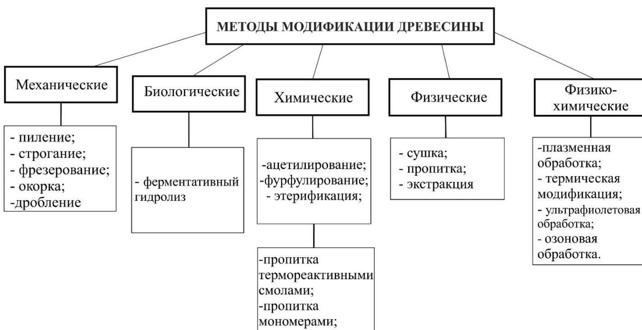
*Рисунок 1.1 – Классификация методов модификации древесного наполнителя*
