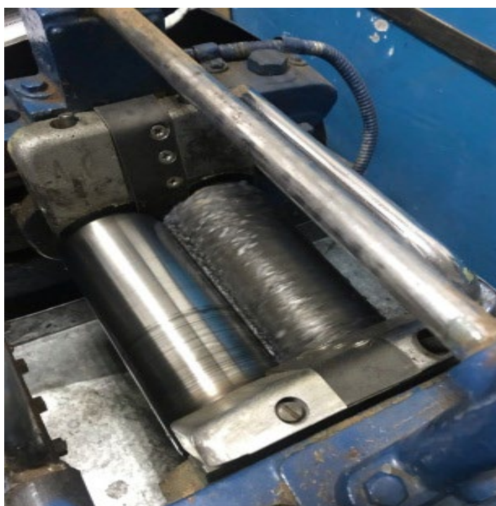
Рисунок 2.5 – Лабораторный вальцовый смеситель
