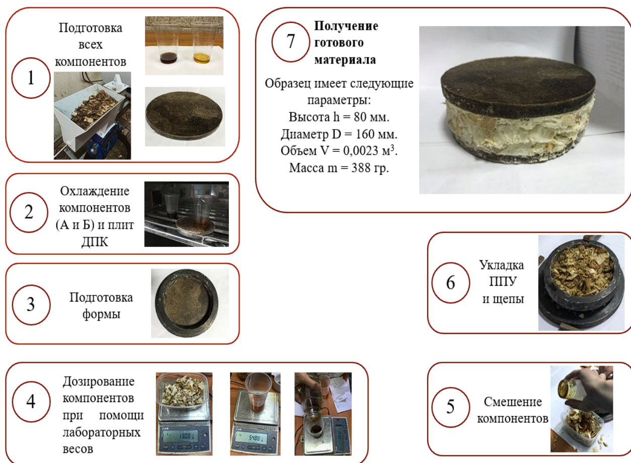
Рисунок 2.8 – Схема получения теплоизоляционного слоя трёхслойного древесно-полимерного материала
