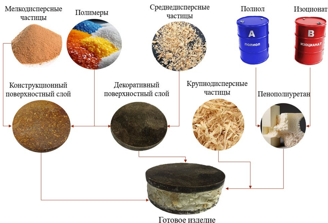
Рисунок 2.1 – Трёхслойный материал на основе ДПК
