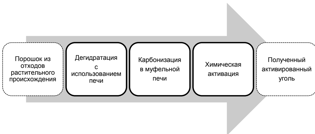
Рисунок 1.2 – Схема этапов термической модификации растительных отходов для получения адсорбента
