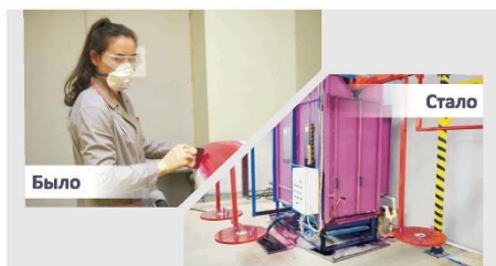
Автоматизированная установка пропитки пенетрантом. Позволила сократить излишние перемещения на 200 км. в год.
