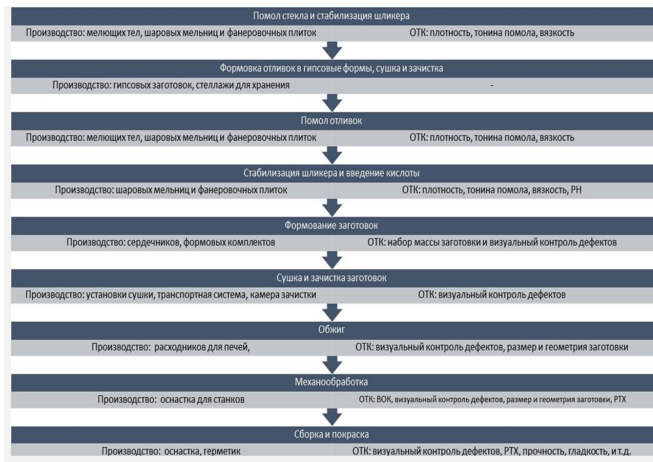
Рисунок 2.1 – Принципиальная технологическая схема изготовления изделий на основе литийалюмосиликатного стекла (составлено автором) [10]
