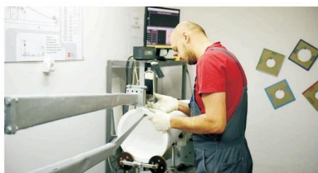
Автоматизация контроля за вводом данных от измерительной скобы сокращает влияние человеческого фактора на процесс контроля геометрических размеров изделий.
