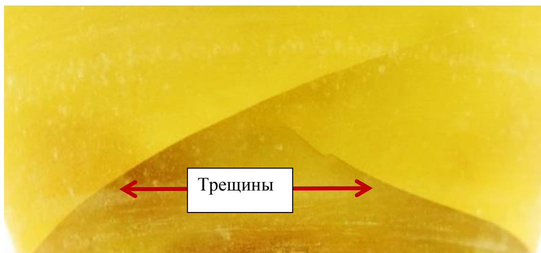
Рисунок 2.9 – Трещины, появившиеся на пуансоне в ходе его эксплуатации (составлено автором) [159]
