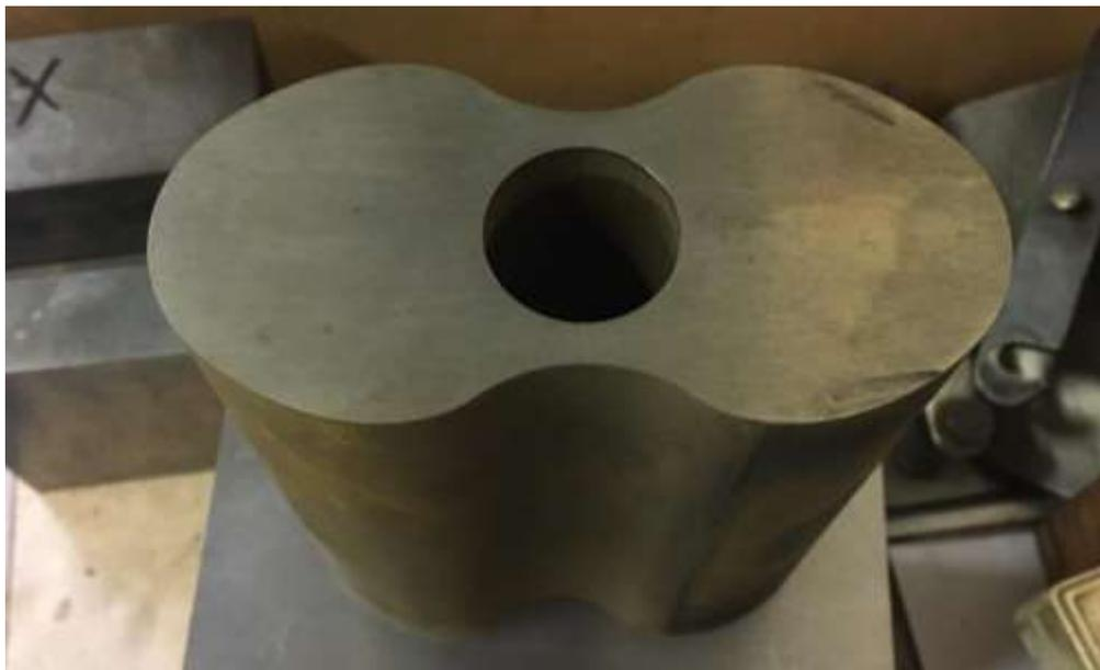
Рис. 2.5 – Эвольвентный профиль ротора
