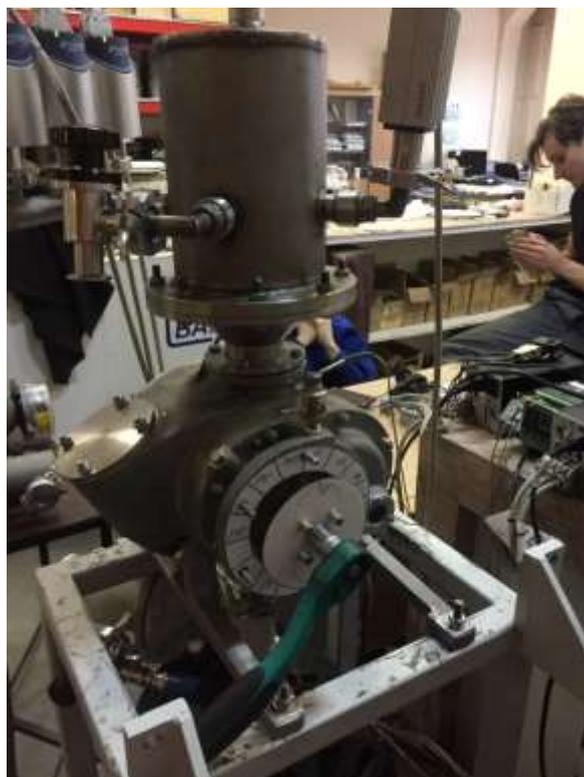
Рис.2.18. Схема установки градусного лимба для контроля угла поворота роторов
