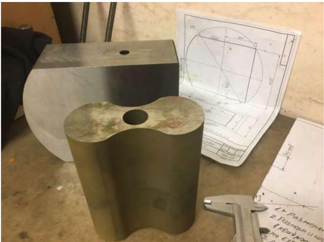
Рис. 2.3 - Эллиптический профиль ротора (патент № 2730769)
