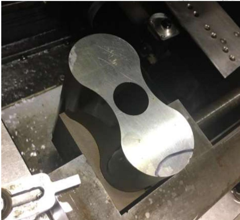
Рис. 2.4 – Эллиптический профиль ротора с параметрами  $\frac{b}{a} = 0,892$  и
