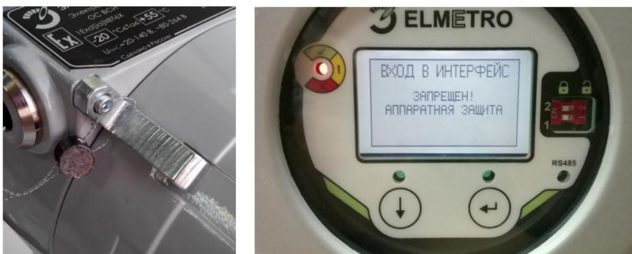
Рисунок 4.4 – Место пломбирования расходомера и сообщение на дисплее при запрещающем положении микропереключателей
