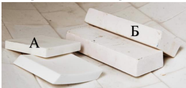
Рисунок 5 – Сравнение формы плиток, изготовленных по старой технологии и конструкции (А) и новой технологии и конструкции (Б)
