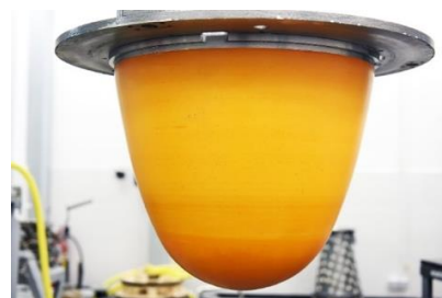
Рисунок 4 – Сердечник - пуансона, формирующего внутренний контур заготовки
