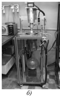
Рисунок 5 – Установка для высокотемпературного гидролиза с кольцевым обогревателем и сливом: а) принципиальная схема: 1 – сосуд гидролизера; 2 – магнитная мешалка; 3 – стакан для сырья; 4 – термопара внутри стенки; 5 – термопара внутри гидролизера; 6 – сливной кран; 7 – предохранительный разрывной клапан; 8 – крышка гидролизера; 9 – якорь магнитной мешалки; 10 – сита; 11 – блок управления; 12 – змеевик; 13 – патрубок входа; 14 – патрубок выхода; 15 – электронагреватель; 16 – стол; 17 – сосуд для слива гидролизата; б) общий вид установки
