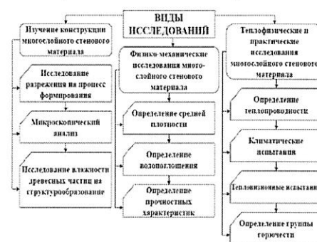
Рисунок 2 – Виды исследований образцов ДПК для трёхслойного стенового материала
