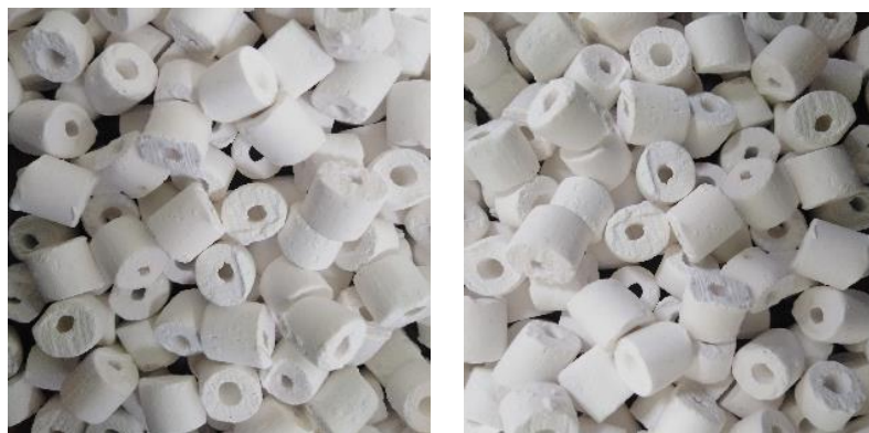
Рис. 3.8 – Гранулы оксида алюминия до (слева) и после (справа) гидротермального модифицирования ГТО 185_240
