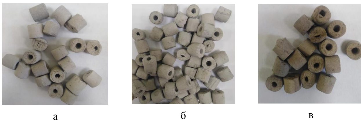
Рис. 3.14 – Гранулированные палладиевые катализаторы: а) Pd(0,2)/ГТО-ОА; б) Pd(0,3)/ГТО-ОА; в) Pd(0,4)/ГТО-ОА
