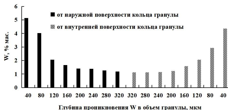
Рис. 3.30 – Концентрационный профиль W по сечению гранулы
