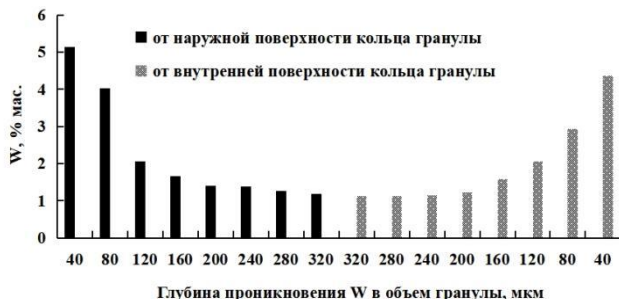
Рис. 9 – Локальная концентрация вольфрама по сечению гранулы катализатора (СЭМ, энергодисперсионная спектроскопия)
