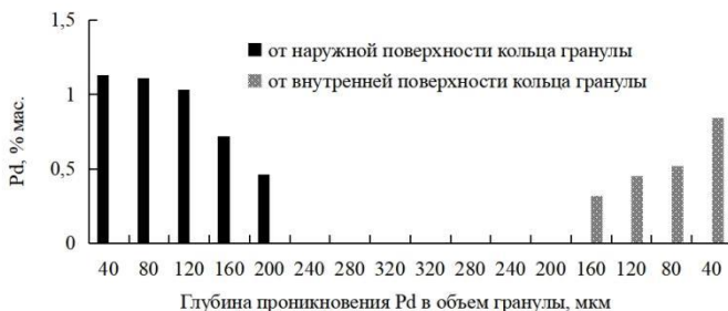
Рис. 7 – Концентрация Pd в поперечном сечении гранулы (СЭМ, энергодисперсионная спектроскопия)
