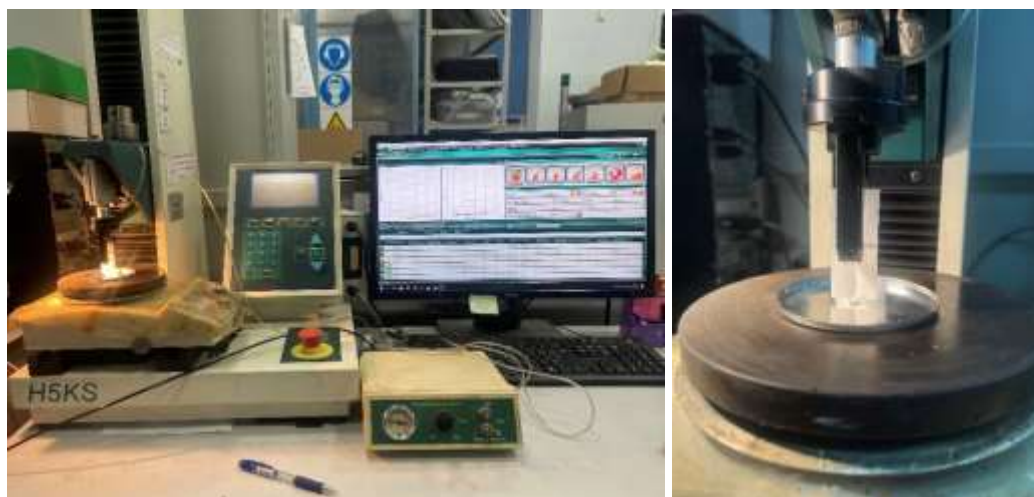
Рисунок 49. Установка для определения прочности межфазного взаимодействия методом вытягивания из капли
