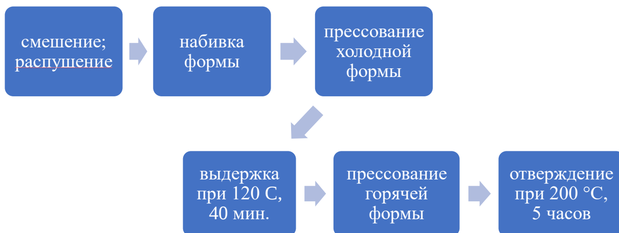
Рисунок 38. Блок-схема процесса изготовления модельных образцов.
