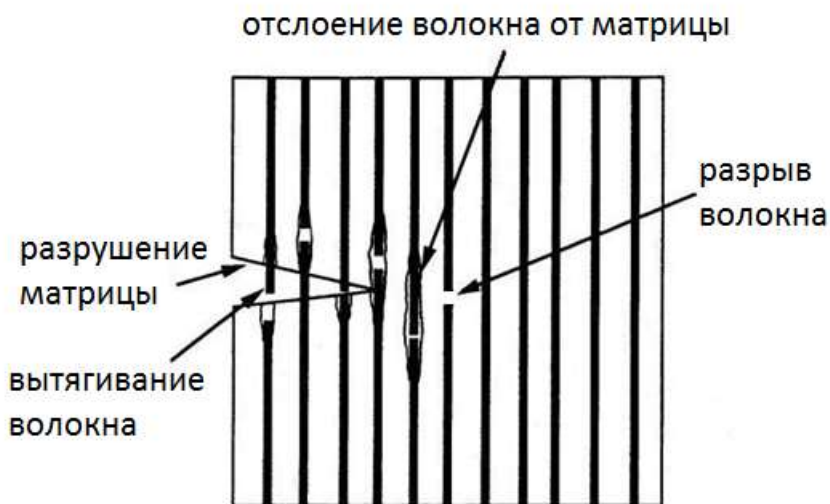
Рисунок 10. Пути поглощения энергии разрушения в композиционном материале
