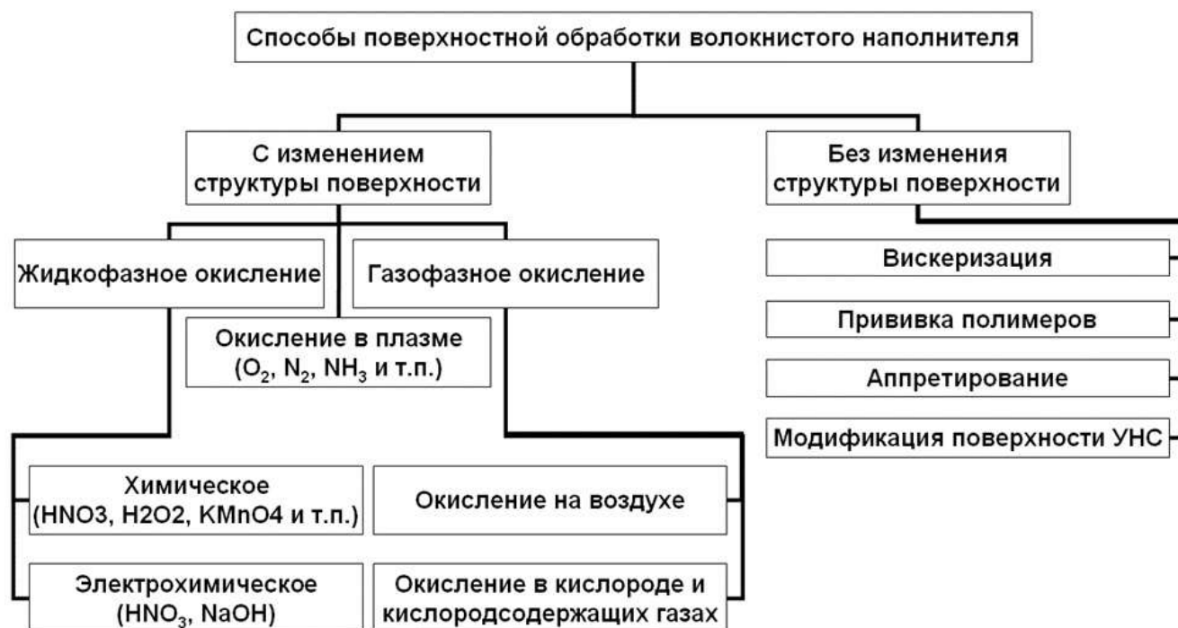
Рисунок 32. Основные типы поверхностной обработки углеродных волокон
