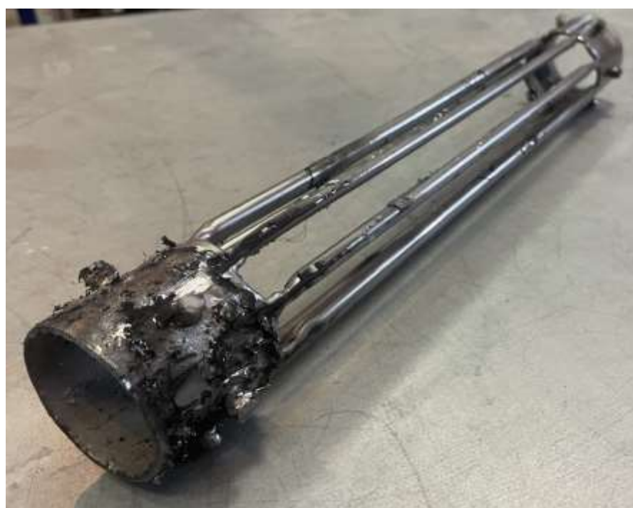
Рисунок 42. Кварцевый держатель для волокна
