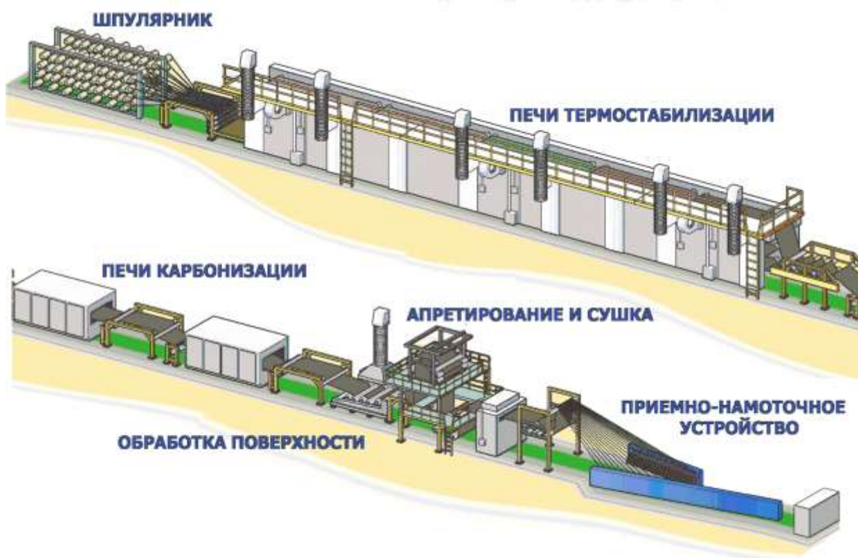
Рисунок 4. Технологическая схема производства углеродных волокон из ПАН-прекурсора
