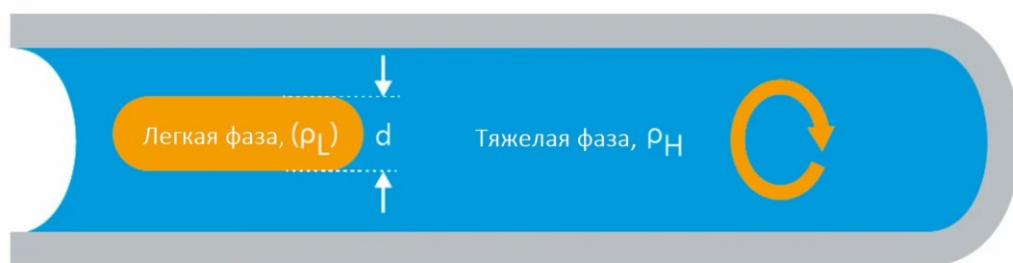
Рисунок 2.1 – Принципиальная схема метода вращающейся капли
