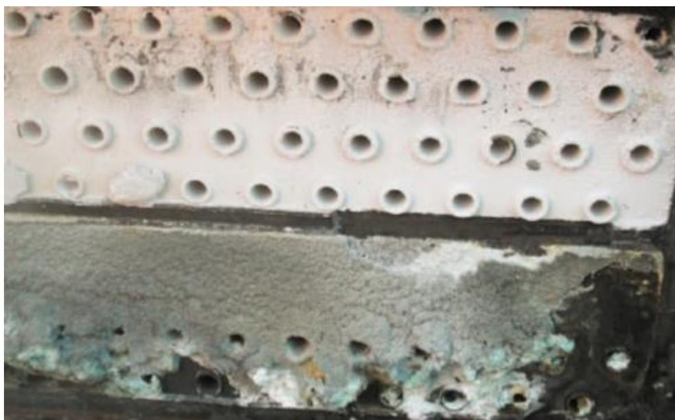
Рисунок 1.5 – Отложения в теплообменнике ХВ-201. 1-я секция установки Изомалк-2 (декабрь 2014 г., остановка в межремонтный пробег)
