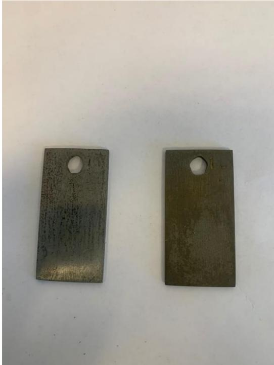
Рисунок 3.12 – Образцы стали 3 и после гравиметрического испытания в течение 24 часов
