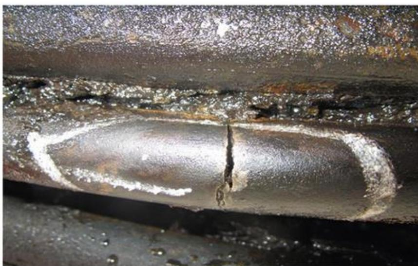
Рисунок 1.7 – Перелом U-образного изгиба теплообменника из-за отложений хлорида аммония
