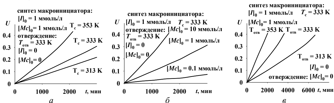
Рис. 8. Расчетные временные зависимости конверсии метилметакрилата в процессе полимеризации метилметакрилата с участием полиметилметакрилатного макроинициатора при различной температуре синтеза макроинициатора (а), различном отношении [Mc]_0/[I]_0 при синтезе (б) и различной температуре отверждения (в); отбор макроинициатора для клеевой композиции проводился при U = 0.6 ; макроинициатор вводился в количестве 3% от массы метилметакрилата; условия процессов указаны на рисунке
