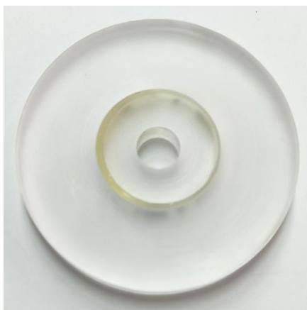
Рисунок 2.3 – Фотография цилиндрического сопла в передней крышке
