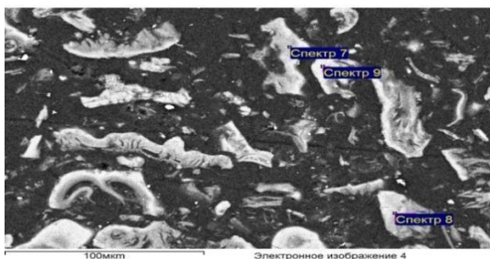
Рисунок 3.21 – Электронно-микроскопический снимок ЗГШ, полученной при 350°C (увеличение 10 000)
