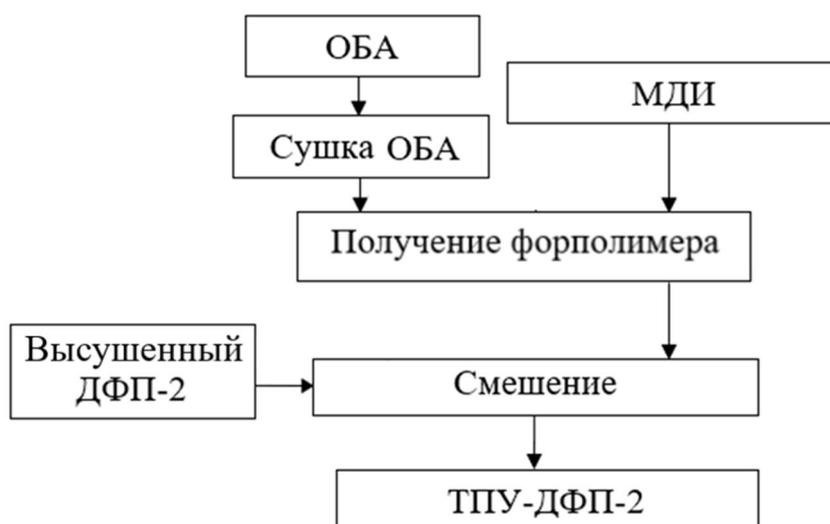
Рисунок 3.10 - Технологическая блок-схема получения ТПУ-ДФП-2 двухстадийным способом
