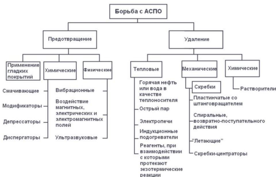
Рисунок 1.2 – Схема способов предотвращения и удаления АСПО
