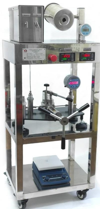
Рисунок 2.1П - Внешний вид экспериментальной установки для исследования фазового равновесия бинарных систем с использованием оптической ячейки высокого давления
