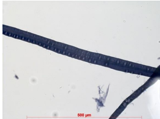
Рисунок 3.3 – Волокна фильтровальной бумаги после обработки реактивами Херцберга и Граффа: а) 1000 рт; б) 1000 рт; в) 500 рт
