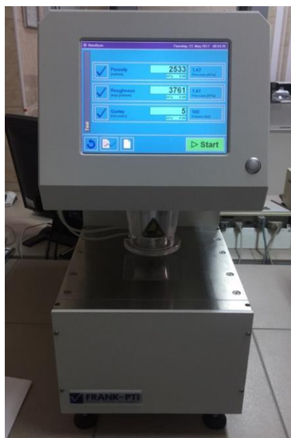
Рисунок 2.9 – Прибор для определений значений шероховатости, пористости и воздухопроницаемости бумажных фильтрующих материалов
