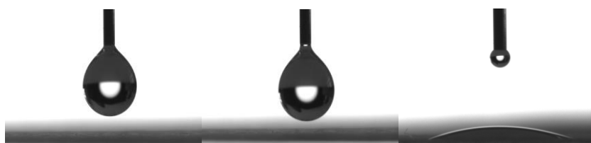
Рисунок 3.9 – Определение краевого угла смачивания электретирированного образца «Черная лента»
