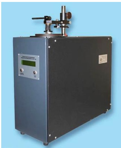
Рисунок 2.10 – Оборудование для измерения воздухопроницаемости текстильных материалов ВПТМ-4
