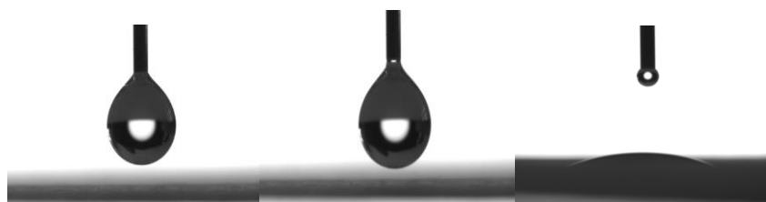
Рисунок 3.8 – Определение краевого угла смачивания электретирированного образца «Синяя лента»
