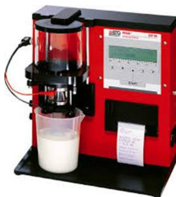
Рисунок 2.11 – Анализатор дзетта-потенциала Mutek SZP-06
