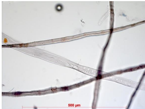
Рисунок 3.3 – Волокна фильтровальной бумаги после обработки реактивами Херцберга и Граффа: а) 1000 рт; б) 1000 рт; в) 500 рт
