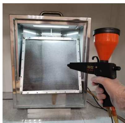
Рисунок 2 – Распылитель СТАРТ-50 и камера для напыления "МИНИСТАРТ" с углетканью в токопроводящей рамке (а) и микрофотографии поверхности ткани и пустот между нитями после напыления в электростатическом поле (б)
