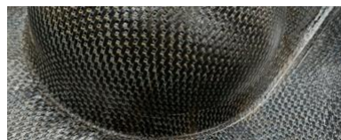
Рисунок 14 - Общий вид рамы с закрепленной в ней деталью (а) из консолидированных плит на основе бензоксазинового связующего после извлечения из пресса (б)
